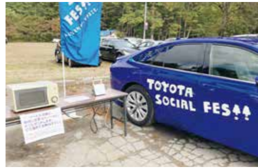
MIRAIからLEDライトと電子レンジに給電している様子
